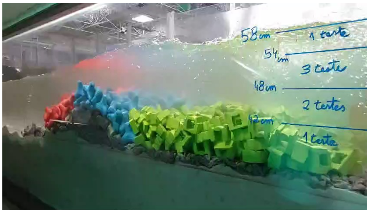
Vídeo. 3 – Movimento dos blocos da estrutura híbrida
