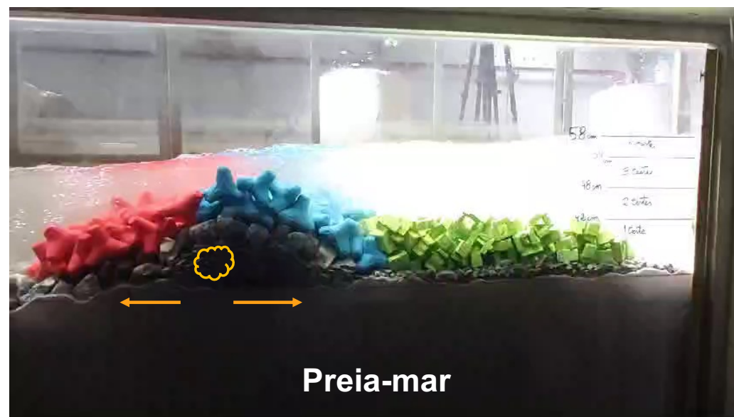
Vídeo. 6 – Configuração híbrida com maré 54 cm.
