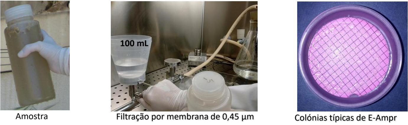
Figura 2. Esquema da técnica de filtração por membrana de E-Ampr para contagem e isolamento.
